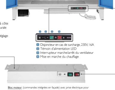
brancher d'autres armoires (branchement en série : 6 maximum). Montage/démontage facile par le bas de l'armoire (6 boulons à défaire)
