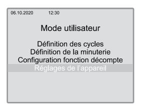
■ Pour régler la date et la langue, sélectionnez « Réglages de l'appareil » puis appuyez sur « ⊗ ».
